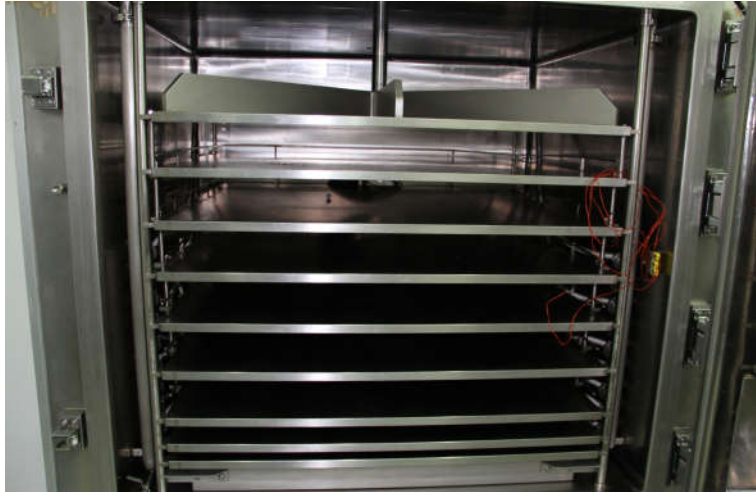
ภาพที่ 29 ภายใน chamber ซึ่งประกอบด้วย plate จำนวน 8 ชั้น
